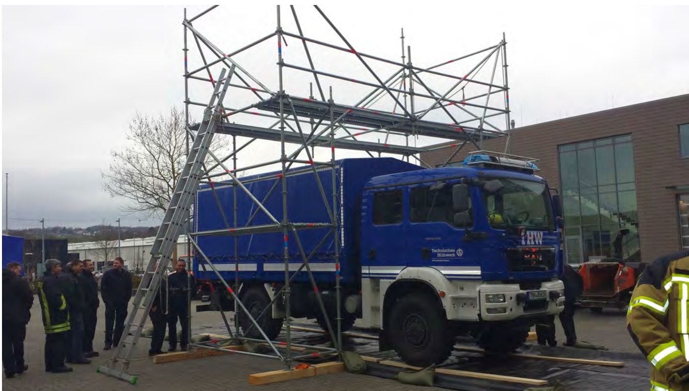
Dekontaminationsplatz für LKWs, aufgebaut vom THW Hagen
