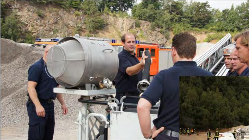
ten wurden in den Leiterpark gelegt und hinter der Drehleiter wurde der Hochleistungslüfter an die Lutten angeschlossen. Eine gute Qualität des Schaumes konnte bis zu einer Höhe von ca. 12m erreicht werden, dann wurde der Gegendruck am Zumischer zu hoch (über 2,2 bar).
